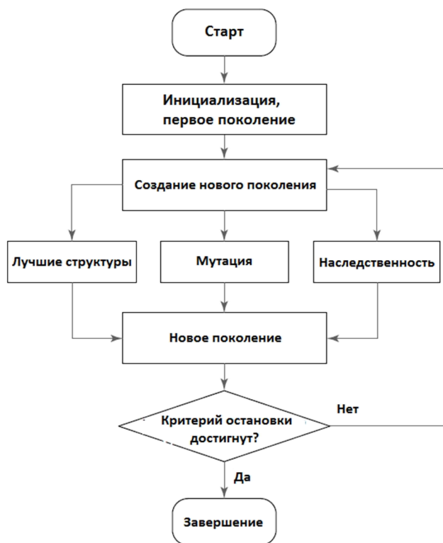
Рисунок 1. Основные шаги типичного эволюционного алгоритма
