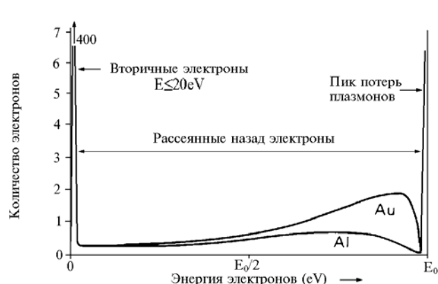
Рис..б. Энергетический спектр электронов покидающих поверхность мишени под действием электронов зонда.
