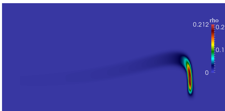
Рис. 6. Поток капль под действием ветра и гравитации
