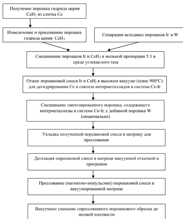
Рис.8. Технологическая схема процесса изготовления МСК
