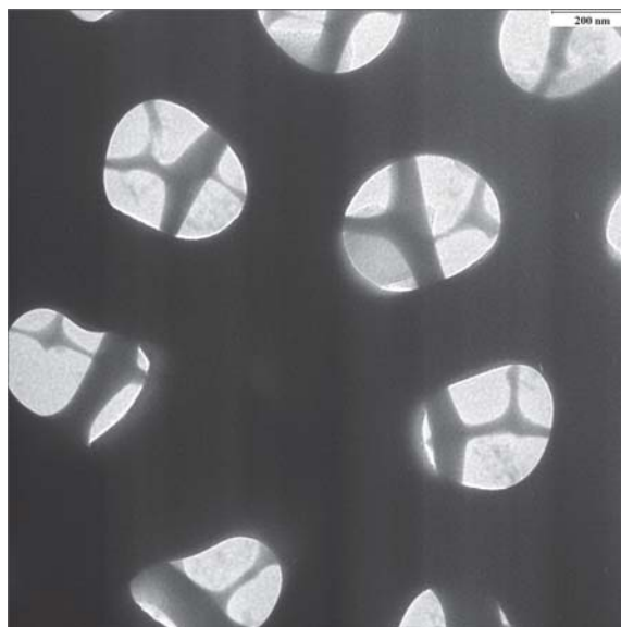
Рис. 4. Изображение мембраны анодированного оксида алюминия с порами диаметром 200 нм, полученное на просвечивающем электронном микроскопе
