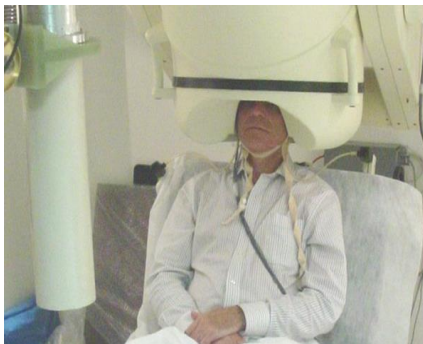
Пример измерений магнитоэнцефалографии с помощью НТСП и ВТСП СКВИД систем [4].
