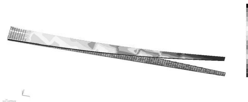
Рис. 10. НДС кессона с композиционными обшивками ориентации волокон минус 20
