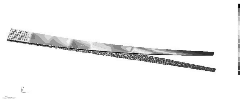
Рис. 8. НДС кессона с композиционными обшивками ориентации волокон минус 20^\circ
