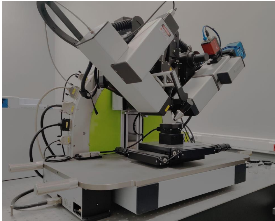
Рисунок 2.2 — Фото эллипсометра Accurion EP4, используемого в данной работе для исследования оптических свойств микрокристаллов \text{As}_2\text{S}_3 , \text{GeS}_2 и других слоистых материалов, полученных методами механического расщепления.
