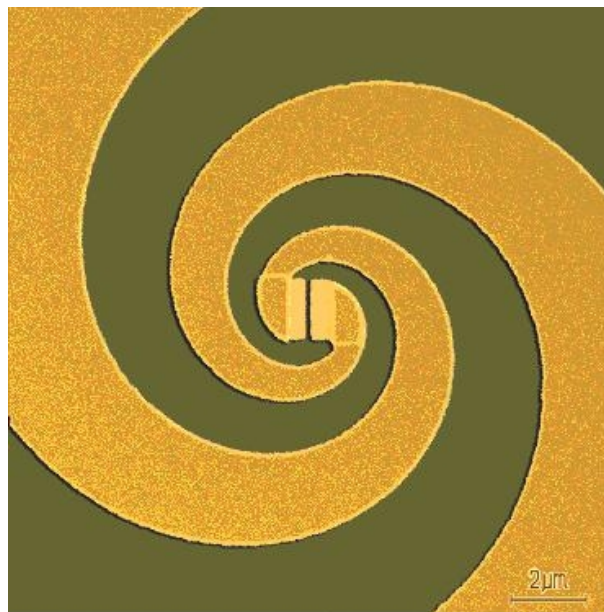
Рис. 2. Фотография чувствительного элемента сверхпроводникового НЕВ болометра, интегрированного с планарной спиральной антенной
