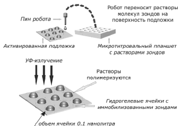
Рис. 1. Схема изготовления гидрогелевого микрочипа [14]
