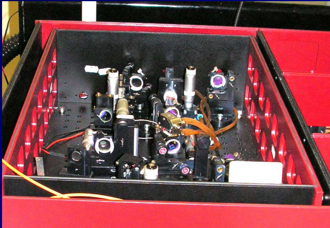
Внешний вид фемтосекундного задающего генератора
