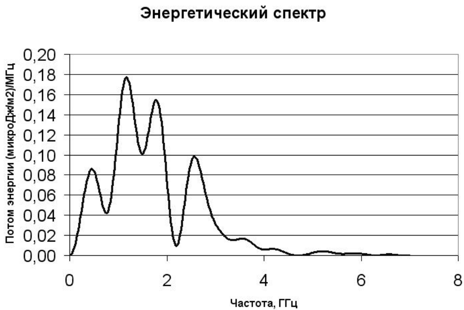
Рис. 2. Спектр потока энергии СШП ЭМИ, используемых в установке «ГИН Био»
