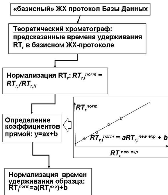
Рис. 3. Схематическое представление предложенной в работе процедуры нормализации экспериментальных хроматографических данных для пептидов на основе модели BioLCCC
