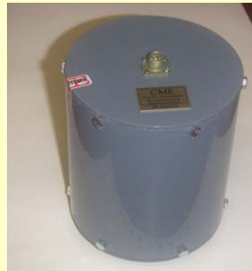
Сейсмометр с МГД обратной связью
