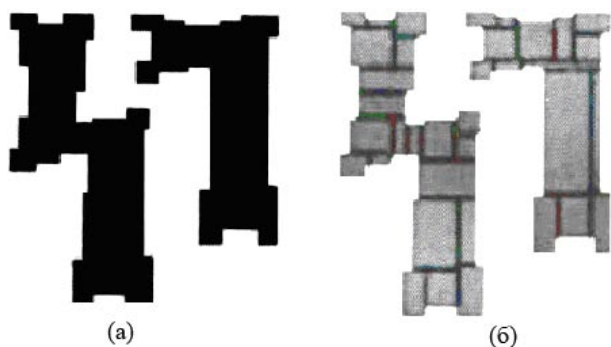
Рис. 5. Разбиение рисунка на фрагменты при электронной литографии: (а) — исходный рисунок; (б) — разбиение
