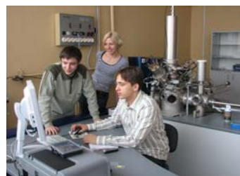
Сверхвысоковакуумная установка для исследования поверхности кристаллов
