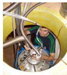
Криостат со сверхпроводящим соленоидом на 17.5 Тл
