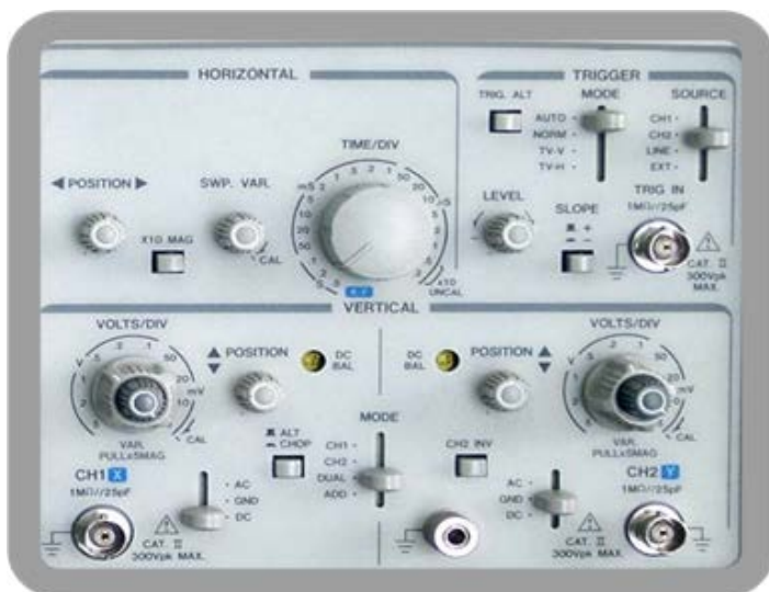
Рис.2. Расположение ручек управления на передней панели осциллографа
