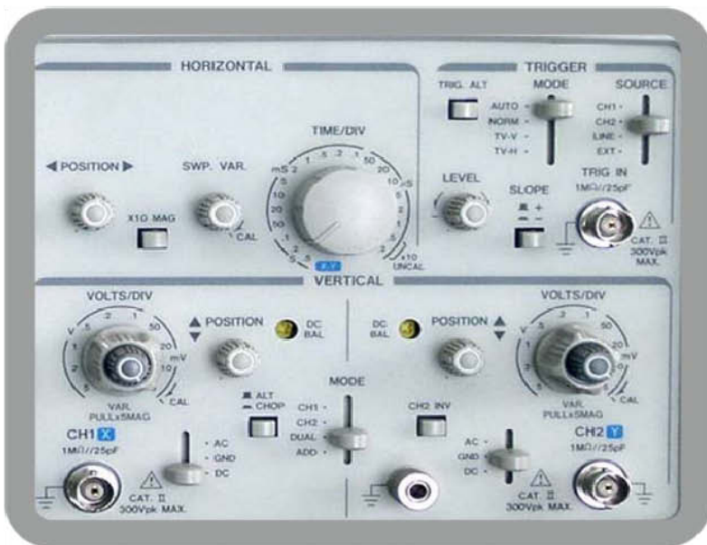
Рис. 2. Расположение ручек на передней панели осциллографа
