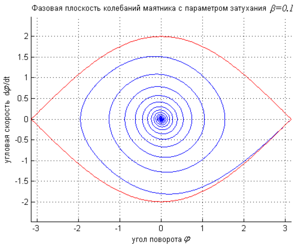
Рис. 1: Пример фазового портрета для нелинейного маятника с затуханием вычисленный с помощью численного интегрирования уравнения движения (3)
