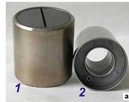
Рис. 2 фрагменты конструкции blankets из нанокаркаса для термоядерного реактора ИТЭР
