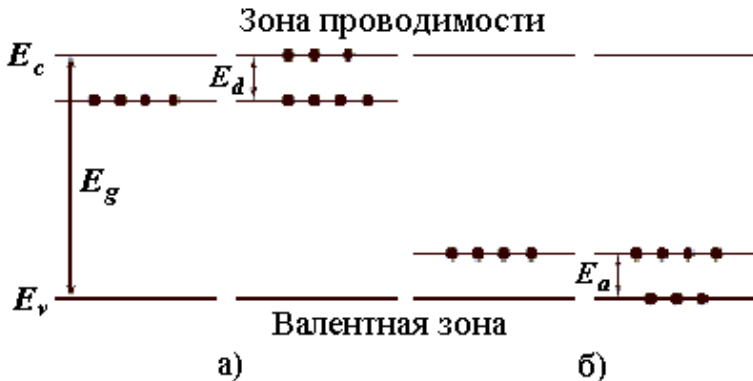
Рис. 3. Энергетические уровни примеси: а) донорный; б) акцепторный.
