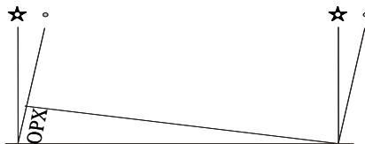
Рис. 1. Разность хода в звездном интерферометре
