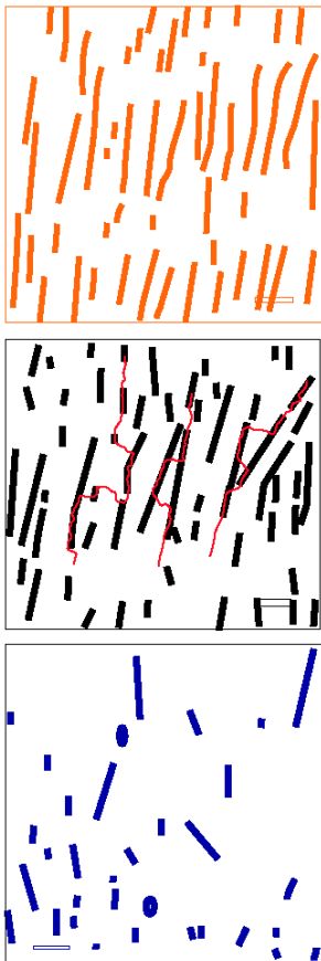
Рис. 1. Включения \text{BaZrO}_3 в пленках \text{YBa}_2\text{Cu}_3\text{O}_7 , полученных при различных температурах подложки T_0 = 840^\circ\text{C} , 785^\circ\text{C} , 765^\circ\text{C} (сверху вниз). Рисунок сделан на основании данных просвечивающей электронной микроскопии. Красные линии – предполагаемое расположение магнитных вихрей, прикрепленных одновременно к нескольким центрам пиннинга. Масштабная шкала 25нм.
