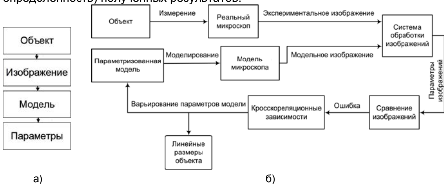
Рис. 5. Подход к измерениям: а) – традиционный; б) – основанный на дополнении экспериментальных изображения модельными данными, их параметризации и оптимизации до получения наилучшего совпадения.
