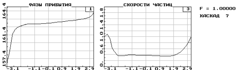
Рис.12. Фазы прибытия электронов и распределение скоростей электронов одного периода на выходе из зазора выходного резонатора.
