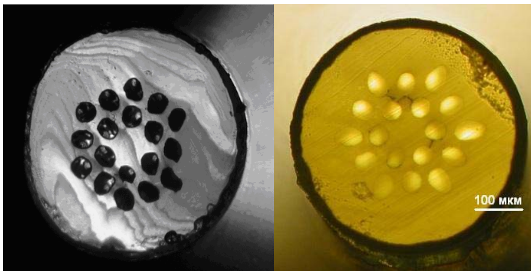
Рис. 6 Фотографии торцов полученных микроструктурированных волокон из кристаллов \text{AgCl}_{0.2}\text{Br}_{0.8} - \text{AgCl}_{0.5}\text{Br}_{0.5} (слева) и \text{AgCl}_{0.5}\text{Br}_{0.5} - \text{AgCl}_{0.55}\text{Br}_{0.45} (справа)
