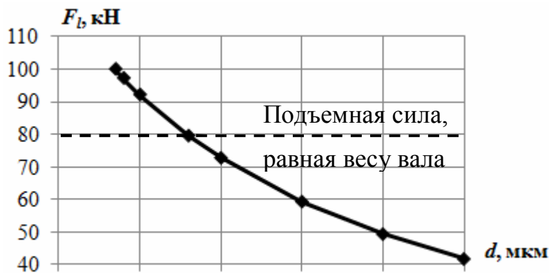
Рис. 7. Зависимость подъемной силы ( F_1 ), действующей на вал, от величины зазора ( d )
